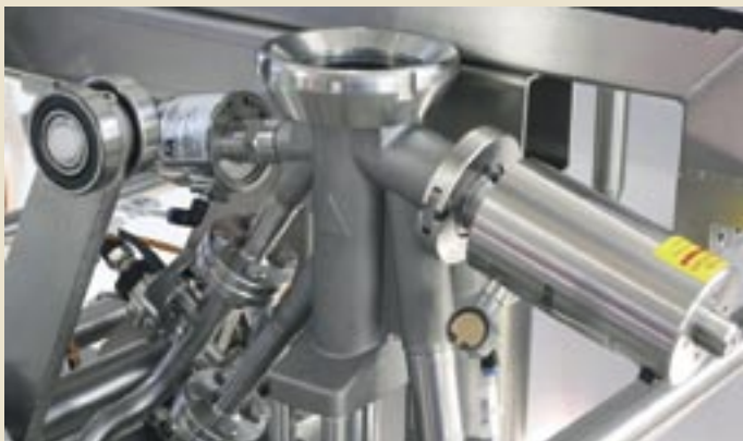
Abb. 3 Füllkopf-Grundkörper mit optimaler Füllkopfüberschwallung
