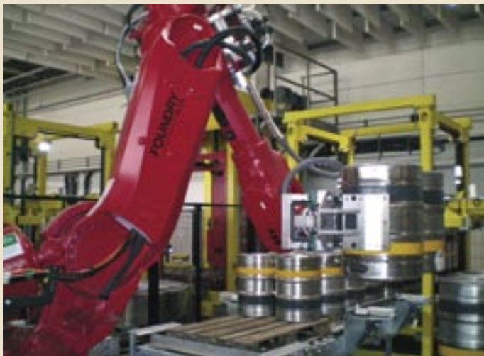
Abb. 2 Der Sechssachs Knickarm-Roboter entpalettiert Kegs mit einem Doppel-Greifer und stellt sie auf den Gebindettransport
