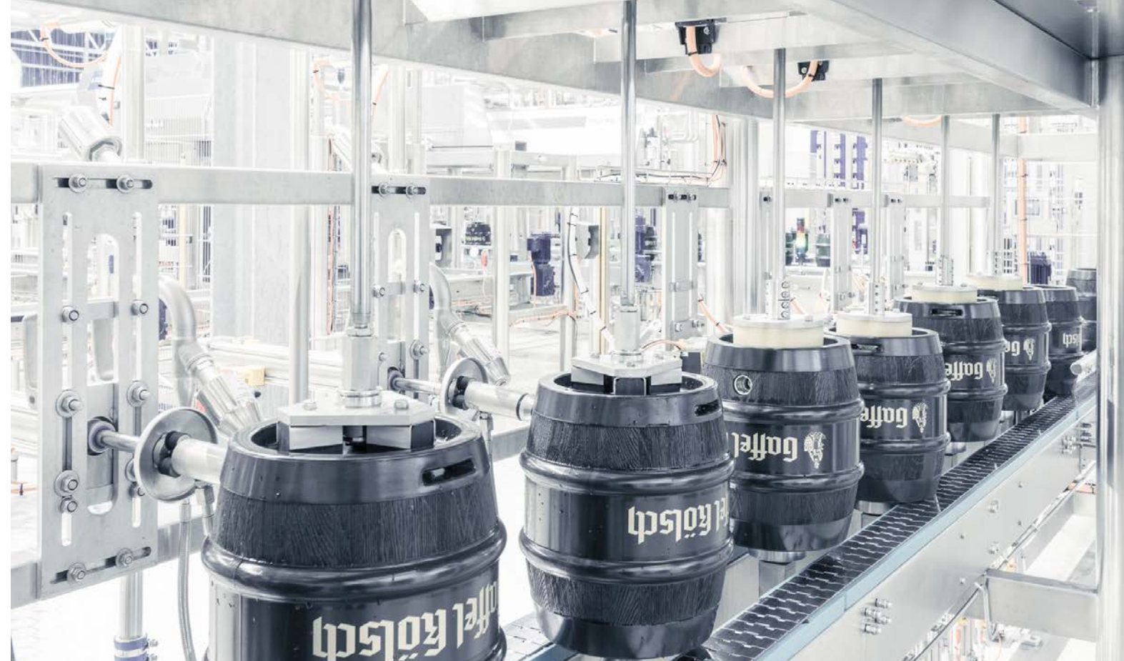
Restentleerung einer sechsbahnigen vollautomatischen KEG-Anlage mit einer Leistung von 600 KEG pro Stunde.
